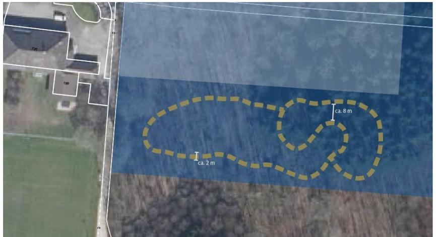
Abbildung 16: Beispielhafter Verlauf einer Pumptrack-Anlage mit einer Länge von ca. 350 m, einem Bahndurchmesser von ca. 2 m und einem Minimalabstand der Bahnen von ca. 8 m. Dunkelblau dargestellt die Fläche der Freizeitzone, hellblau der Perimeter des Seilparks.
